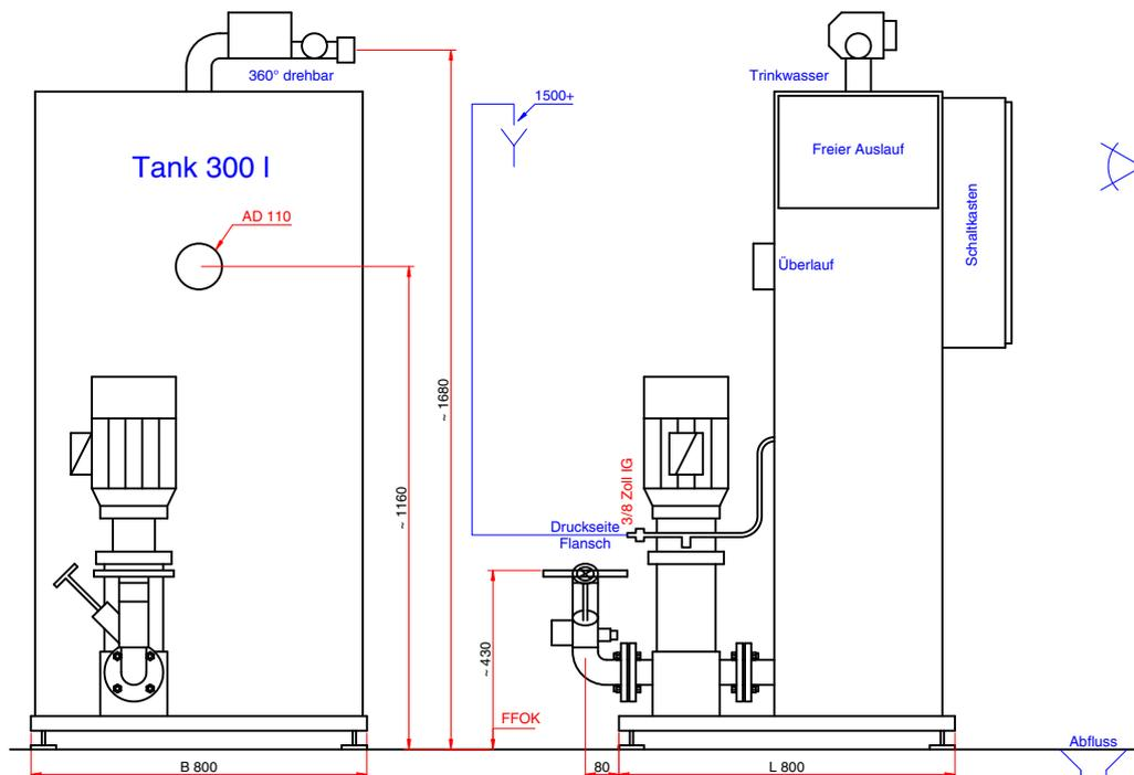
Maximal zulässiger Anlagendruck PN16; Platzbedarf für Wartung: 50 cm rundum; Am Aufstellungsort für eine ausreichend dimensionierte Abflussmöglichkeit sorgen! Hinweise zu elektrischen Anschlussleistungen in der Errichteranleitung beachten!
