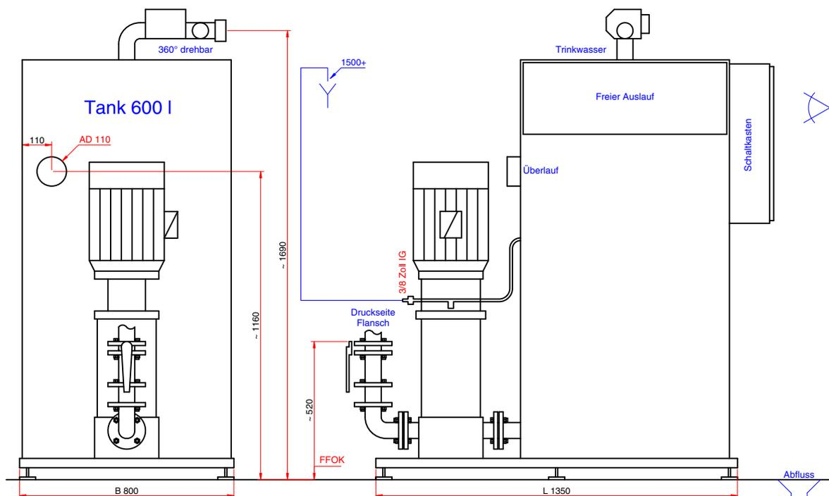
Maximal zulässiger Anlagendruck PN16; Platzbedarf für Wartung: 50 cm rundum; Am Aufstellungsort für eine ausreichend dimensionierte Abflussmöglichkeit sorgen! Hinweise zu elektrischen Anschlussleistungen in der Errichteranleitung beachten!
